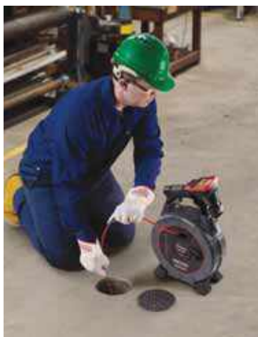
SeeSnake microDrain con micro CA-350 utilizado como monitor y dispositivo de grabación.
