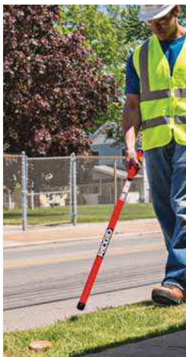
Localice con precisión cierras de bordillo y otros objetos subterráneos que contienen hierro.
