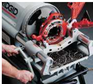
Modelo 714 (914) Cabezal de roscar de retroceso
